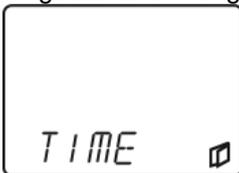
Drücken Sie die "BOOST/OK"-Taste, um das Menü zu öffnen. Mit dem Wählrad können Sie die Zeit (0-60 Minuten) einstellen, wie lange das Fenster geöffnet wird, unabhängig von der Tageszeit. Bestätigen Sie mit der "BOOST/OK"-Taste. Wenn 0 als Zeit hinterlegt ist, funktioniert dieser Modus nicht.
