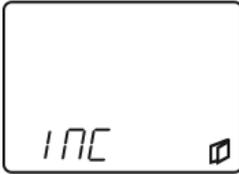
Drücken Sie die "BOOST/OK"-Taste, um das Menü zu öffnen. Mit dem Wählrad können Sie den Temperaturanstieg von 0,2°C – 3°C einstellen, bei dem dann der "Fenster-offen"-Modus deaktiviert werden soll. Bestätigen Sie Ihre Eingabe mit der "BOOST/OK"-Taste.
